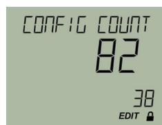
Figure 9-4 Compteur des modifications de configuration
