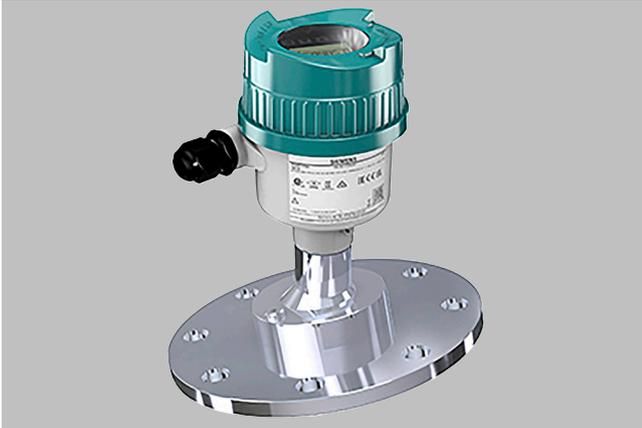
Le SITRANS LR580, avec antenne lentille, permet la surveillance en continu du niveau de solides ou de liquides ; plage de mesure jusqu'à 120 m (394 ft). La conception avec bride d'orientation et raccordement purge (air) intégré permet la mesure de stocks dans les silos. L'appareil est également bien adapté aux applications à haute température dans les industries du ciment et de l'énergie.
