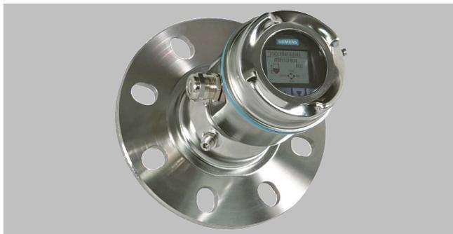
Le SITRANS LR560 est un transmetteur radar, technologie 2 fils, 78 GHz pour la mesure de niveau de solides et liquides. Plages jusqu'à 100 m (328 ft).
