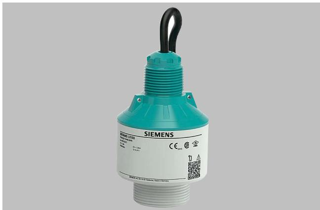
Le SITRANS LR100 est un transmetteur radar alimenté par boucle de courant à 2 fils pour la mesure en continu du niveau de solides et de liquides à l'intérieur des réservoirs sur une plage de 8 m (26 ft).
