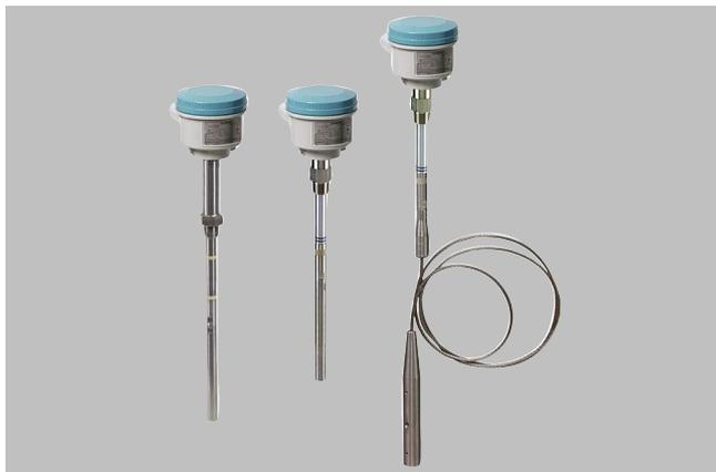
Pointek CLS300 (version standard) est un capteur capacitif à fréquence variable pour la détection de niveau et de matériaux, doté d'une sonde à tige ou à câble et d'une sortie configurable. Le CLS300 est une solution idéale pour détecter les liquides, les solides, les produits moussants, les boues et les interfaces en présence de pressions et de températures extrêmes. Ce détecteur permet en outre d'ignorer les dépôts de produit sur la sonde.
