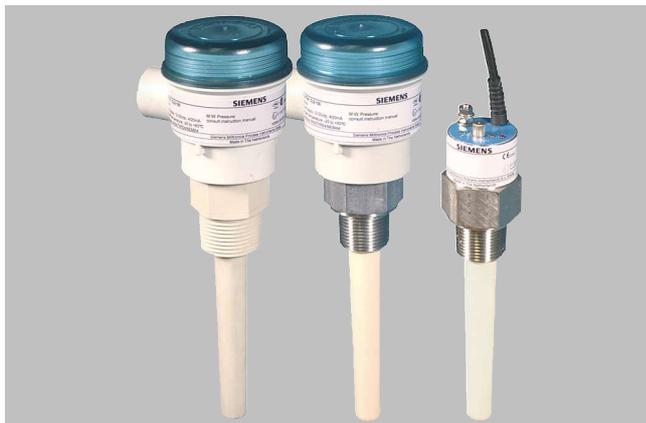
Pointek CLS100 est un détecteur capacitif 2 fils à fréquence variable, compact, adapté aux espaces réduits. Il est conçu pour contrôler le niveau et la présence d'interfaces, de produits en vrac, de liquides, de boues et de produits moussants. Ce détecteur permet en outre d'ignorer les dépôts de produit sur la sonde.
