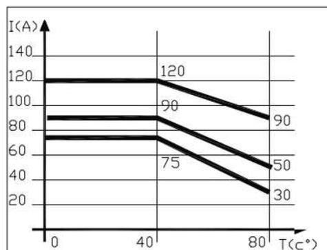
N.B.: Les courbes du GTS 120 se rapportent au dispositif équipé du ventilateur de série en état de fonctionnement
