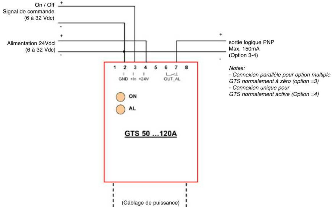
Exemple de raccordement pour GTS avec commande Vca et option alarme (Option 1)
