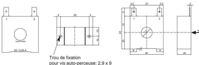
Trou de fixation pour vis auto-perceuse: 2,9 x 9
