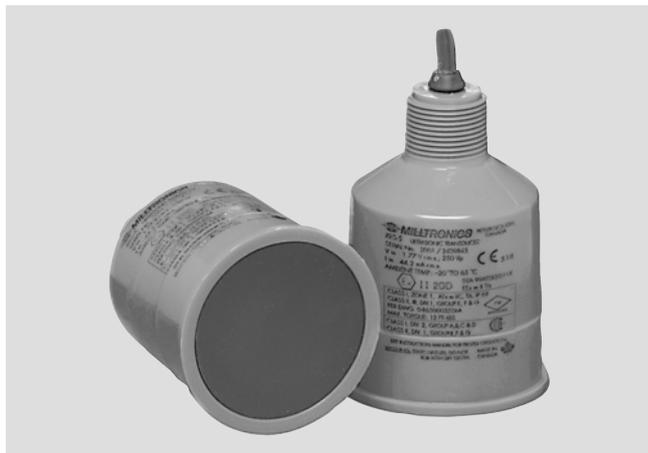
Le transducteur à ultrasons EchoMax XRS-5 garantit la mesure de niveau en continu de liquides et de boues liquides. Solution très fiable pour les stations de relèvement étroites, les canaux, les déversoirs et les lits filtrants, il est doté d'un faisceau d'émission étroit (10°) et d'une face émettrice en caoutchouc CSM.
