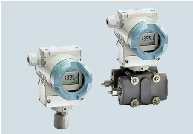
Les transmetteurs de pression numériques SITRANS P310 garantissent un grand confort d'utilisation. Avec une précision de mesure von 0,075 %, ils se positionnent en entrée de gamme et complètent SITRANS P DS III. Le paramétrage est réalisable soit à l'aide des touches de fonction soit par la communication HART.
