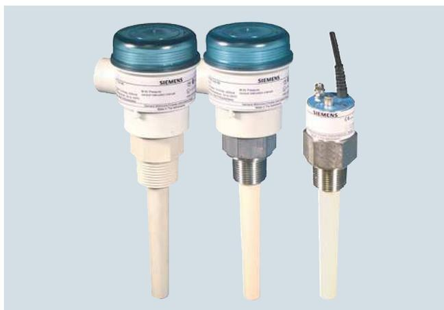
Pointek CLS100 est un détecteur capacitif 2 fils à fréquence variable, compact, adapté aux espaces réduits. Il est conçu pour contrôler le niveau et la présence d'interfaces, de produits en vrac, de liquides, de boues et de produits moussants. Ce détecteur permet en outre d'ignorer les dépôts de produit sur la sonde.
