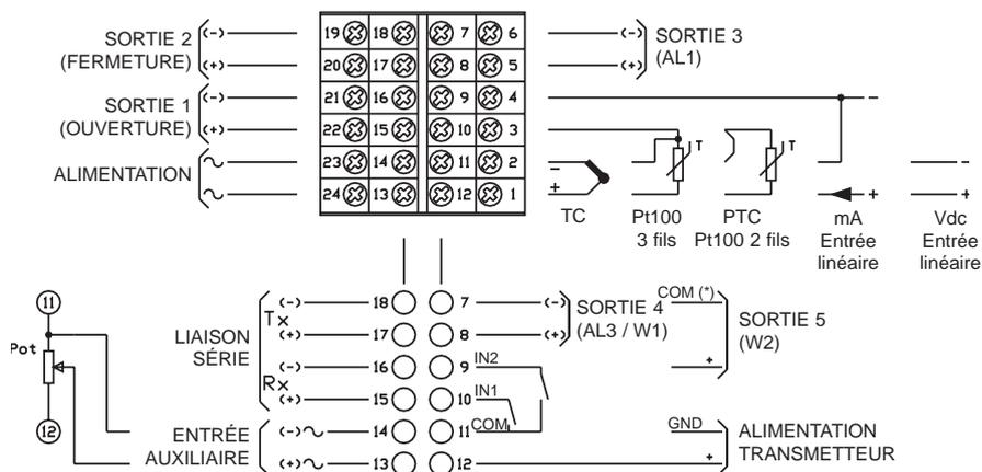
(\*) COM est connecté à la borne 7 si la sortie 4 est continue (W1).
